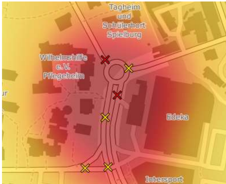
Abbildung 35: Lage der Unfälle am Unfallschwerpunkt Hohenstaufenstraße, Poststraße (Rote Kreuze: Unfälle mit Schwerverletzten, Gelbe Kreuze: Unfälle mit Leichtverletzten) (eigene Darstellung (VAR+, 2023) nach (Statistisches Landesamt Baden-Württemberg, 2023); Kartengrundlage: © OpenStreetMap-Mitwirkende www.openstreetmap.org/copyright )
