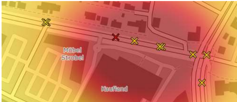
Abbildung 33: Lage der Unfälle am Unfallschwerpunkt Stuttgarter Straße (Rote Kreuze: Unfälle mit Schwerverletzten, Gelbe Kreuze: Unfälle mit Leichtverletzten) (eigene Darstellung (VAR+, 2023) nach (Statistisches Landesamt Baden-Württemberg, 2023); Kartengrundlage: © OpenStreetMap-Mitwirkende www.openstreetmap.org/copyright )
